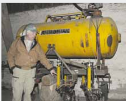
Carsten Stoltze ved den lille forsøgsnedfælder m/skiveskær og højtryksinjektion som man sysler med på Lundemose.
